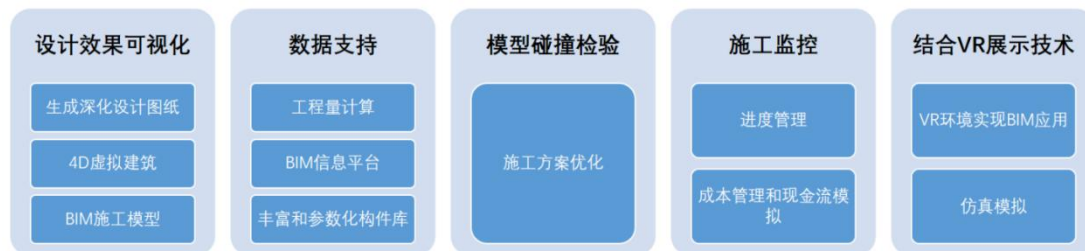
图表 14：BIM 在装配式建筑全流程应用
